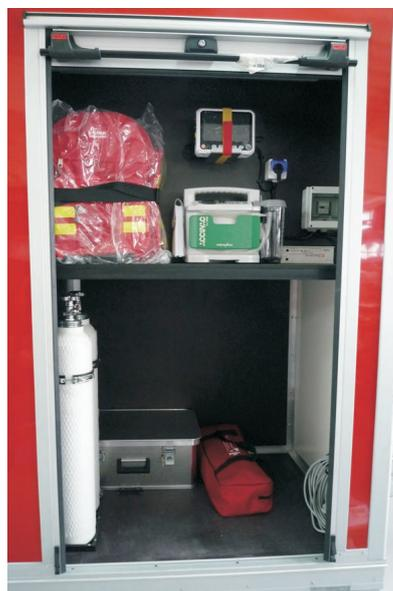
Complementare Autospecialelor pentru Interventii la Dezastre sau, in cazuri exceptionale, substituindu-se acestora sunt Punctele Medicale Avansate (P.M.A.), realizate pe remorci cu axa dubla, cu o structura de aliaj usor si 3 compartimente, inchise cu jaluzele de aluminiu.
