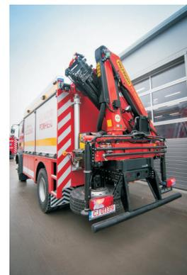
Suprastructura, protejată la exterior cu rasina epoxidica bicomponent, include modulul de stingere, precum și compartimentele destinate descarcerării, dar unde au
