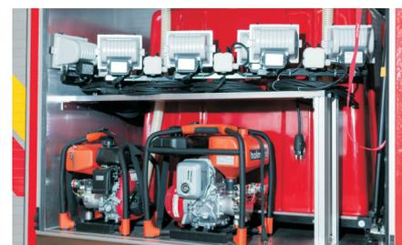
Destinate serviciilor pentru situatii de urgenta, aceste containere asigura depozitarea unui volum mare de echipamente, scule si aparate, ce sunt operationalizate la nevoie, in cazul unor incidente de proportii, prin transportarea containerului pe cale terestra cu ajutorul unor autovehicule dotate cu sistem hidraulic de incarcare/descarcare cu carlig, conform standardului DIN 30722.
