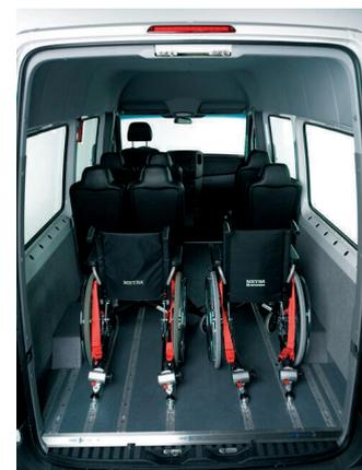
Combinatia dintre sistemul Smartfloor si scaunele individuale omologate M1 rezista unor forte de 3500 daN pentru fiecare scaun, adica peste 10.000 daN pentru un rand de 3 scaune. Optional, scaunele M1 pot fi dotate si cu sisteme ISOfix, pentru a permite fixarea de ele a scaunelor speciale de transport pentru copii.
